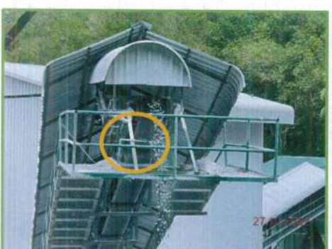
ภาพที่ 2-14 ระบบสเปรย์น้ำบริเวณโรงโม่หินของโครงการ
